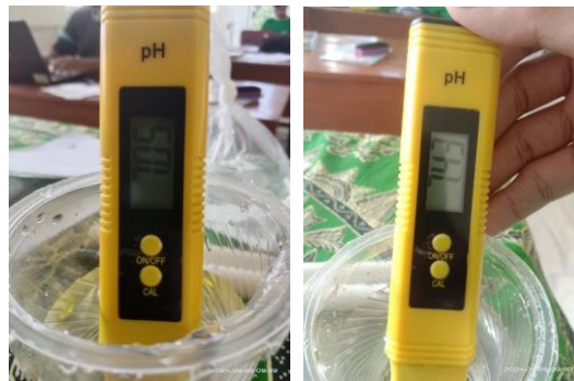
Gambar 5. Pengukuran pH air menggunakan pH meter (Sumber: dokumentasi penulis)
