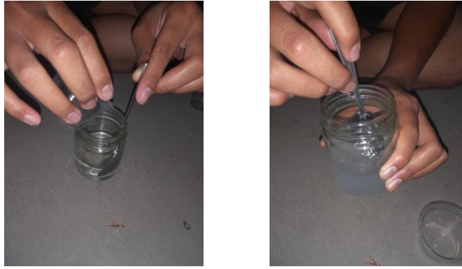
Gambar 12, 13 Penyampuran NaOH dan Minyak
